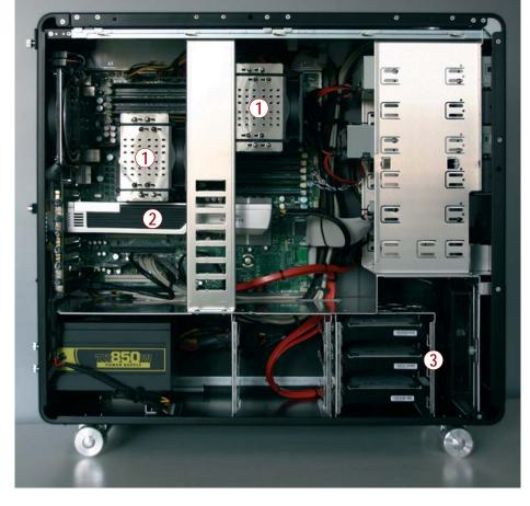
Blickfang für Technik-Freaks: Die MediaStation T2500 ist extrem sauber verarbeitet. Das Innere dominieren die beiden Xeon-Kühltürme ① sowie die Nvidia Quadro CX ②. Zwei der drei Festplatten bilden ein Video-RAID ③.
